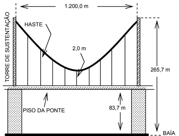
O comprimento de cada uma das hastes que ligam o cabo à ponte, distantes 50,0 m do centro da ponte é, em metros, igual a
