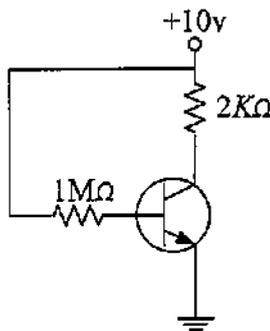
Sabendo que esse circuito utiliza um transistor de junção bipolar e considerando  $\beta_{cc} = 200$  e  $V_{BE} = 0,7$ , é correto afirmar que a corrente de coletor é:
