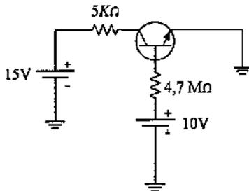
Calcule a corrente de saturação para o circuito transistorizado acima, utilizando um transistor de junção bipolar, e assinale a opção correta.
