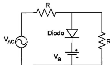
Para uma tensão de pico do sinal senoidal  $V_{AC}$  maior que  $0,7 + V_a$ , é correto afirmar que o circuito a diodo mostrado na figura acima pode ser empregado como um circuito:
