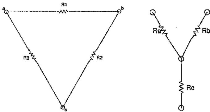
Conforme apresentado os circuitos  $\Delta$  e Y acima, indique quais são as resistências equivalentes  $R_a$ ,  $R_b$  e  $R_c$  em função da transformação do circuito  $\Delta$ -Y.
