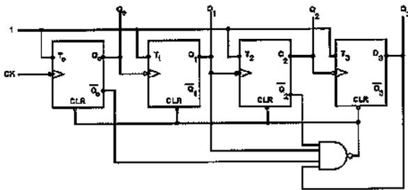
O contador apresentado na figura acima é formado por quatro *flip flops* do tipo T e por uma porta NAND de 4 entradas. Os pulsos de contagem se fazem pela entrada CK e a contagem é dada pelas saídas  $Q_3Q_2Q_1Q_0$ . Esse circuito corresponde a um contador:
