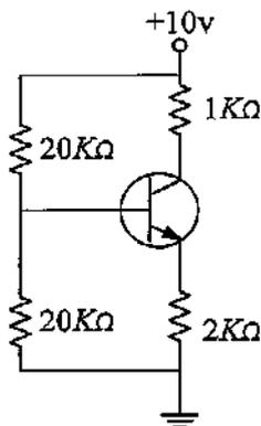
A polarização do circuito transistorizado mostrado na figura acima, utilizando um transistor de junção bipolar com  $\beta = 100$ , faz com que a corrente de emissor seja aproximadamente:
