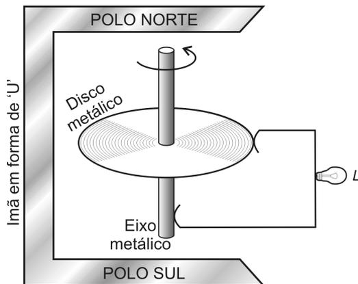
Ao conectar, entre a borda do disco e o eixo metálico de rotação, uma lâmpada  $L$  cuja resistência elétrica tem comportamento ôhmico, a potência dissipada no seu filamento, em função do tempo, é melhor representada pelo gráfico
