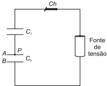
Estando os capacitores completamente carregados, desliga-se a chave  $Ch$  e inclina-se a armadura  $A$  sem deixá-la aproximar muito de  $B$ . Nessas condições, a  $ddp$  nos terminais de  $C_1$  e  $C_2$ , respectivamente,
