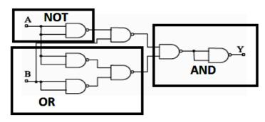
Aplicando *De Morgan*:  $\overline{\overline{A} \cdot B} = A + \overline{B}$
