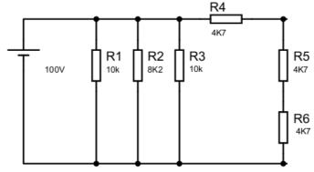
A resistência total é igual a 2545  $\Omega$ . Sendo a condutância o inverso da resistência, tem-se:  $1/R = 1/2545 = 392 \mu S$ .
