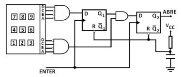
A fechadura é aberta quando  $Q_2$  é igual a 1. Para isso ocorrer, deve-se digitar o primeiro número, que é convertido em BCD, dar um pulso de *clock* na entrada ENTER e repetir o processo para o segundo número. O *bit* D é o mais significativo (MSB) e o *bit* A o menos significativo (LSB). A sequência de dígitos que deve ser digitada para abrir a fechadura é
