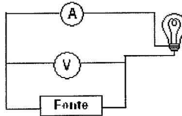
As lâmpadas incandescentes, criadas no século XIX por Thomas Edison, comportam-se como resistores, pois transformam grande parte da energia elétrica consumida em calor e apenas uma pequena parte em luminosidade. Considere que o amperímetro acuse que pelo circuito passa uma corrente de  $0,5A$ , enquanto o voltímetro estabelece uma leitura de  $120V$  entre os terminais da fonte.
