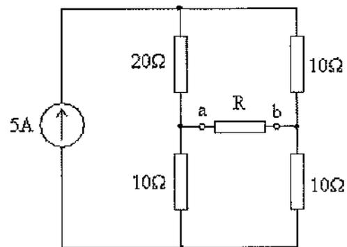
No circuito acima, a tensão  $V_{ab}$  e a resistência  $R$  do circuito equivalente de Thévenin, entre os pontos  $a$  e  $b$ , são, respectivamente:
