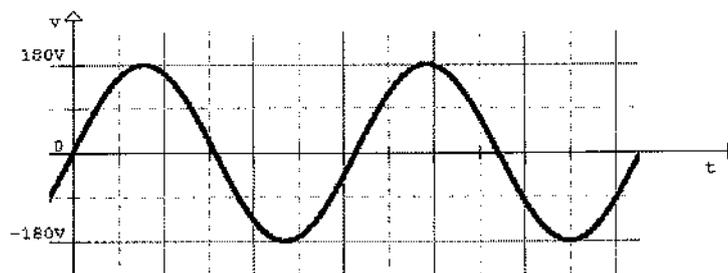
A figura acima corresponde à tensão sobre um resistor, observada em um osciloscópio. Qual é o valor de tensão, em Volts, sobre o mesmo resistor, lido por um voltímetro AC?
