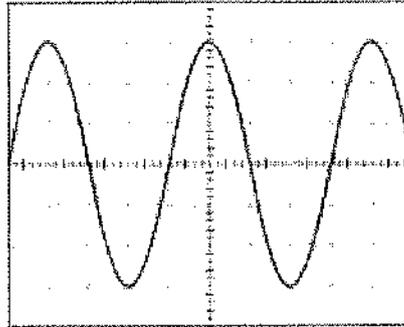
Sabendo que o botão de controle de amplitude do osciloscópio está na posição 2V/DIV (Volts por divisão) e que o botão de controle de posição horizontal está na posição 5 $\mu$ s/DIV (Microsegundos por divisão), qual é o valor, respectivamente, da tensão de pico ( $V_p$ ) e da frequência ( $f$ ) da forma de onda apresentada, considerando a utilização de uma ponta de prova 1:1?
