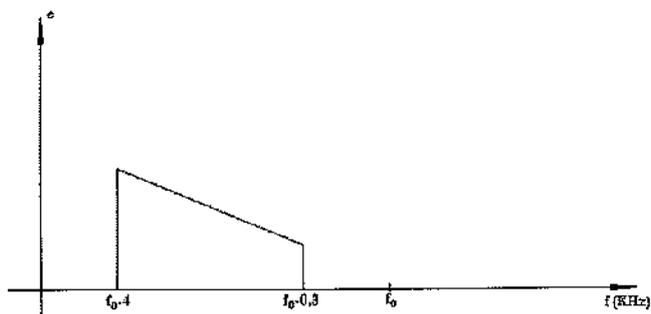
O gráfico acima representa o espectro contínuo de um sinal de áudio de faixa de frequência entre 300Hz e 4kHz, modulado por uma portadora senoidal de frequência  $f_0$ . Sendo assim, assinale a opção que corresponde ao sistema de modulação aplicado ao sinal de áudio.
