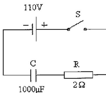
Qual é o valor da tensão, em Volts, do capacitor acima, no tempo de 1 segundo, após a chave S ter sido fechada?
