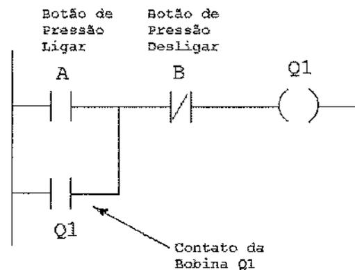
Em relação ao diagrama acima, o contato da bobina Q1 tem a função de
