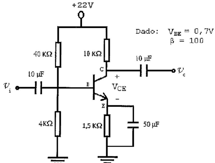
Qual é o valor aproximado, em Volts, da tensão " $V_{CE}$ ", entre o coletor e o emissor do transistor?
