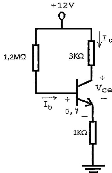
Qual é o valor aproximado, em Volts, da tensão  $V_{ce}$  do transistor acima?
