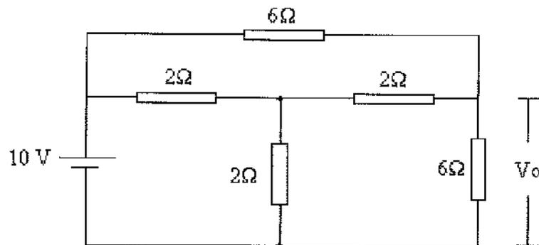
Qual é o valor da resistência equivalente, em Ohms, e o valor da tensão  $V_0$ , em Volts, do circuito acima, respectivamente?
