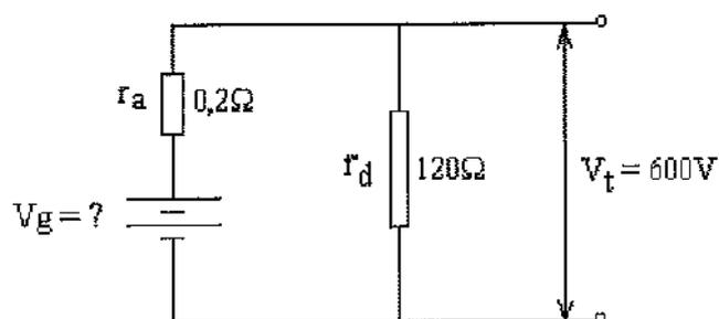
No circuito acima, sabendo que a tensão nominal do gerador de derivação de 75KW é de 600V, a resistência de campo de derivação é de  $120\Omega$  e a resistência da armadura é de  $0,2\Omega$ , qual é o valor da força eletromotriz  $V_g$  gerada?
