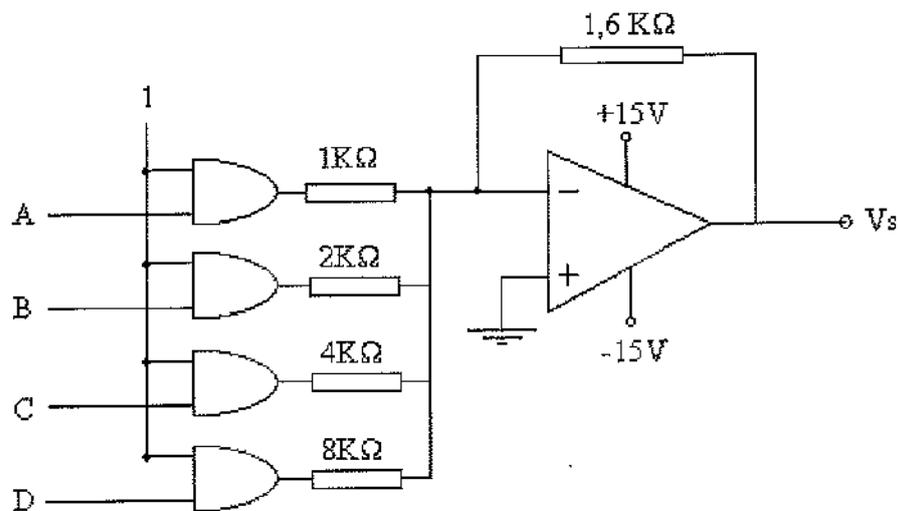
Sabe-se que as portas lógicas do conversor D/A, representado no circuito acima pertencem à família TTL (nível lógico 1 = 5V). Em relação a esse circuito, quais são os valores da tensão de saída  $V_s$  para as entradas ABCD = 0101 e ABCD = 1111, respectivamente?
