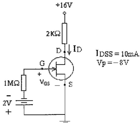
Qual é o valor de  $V_{gs}$  e  $I_D$ , respectivamente, para o FET do circuito acima?
