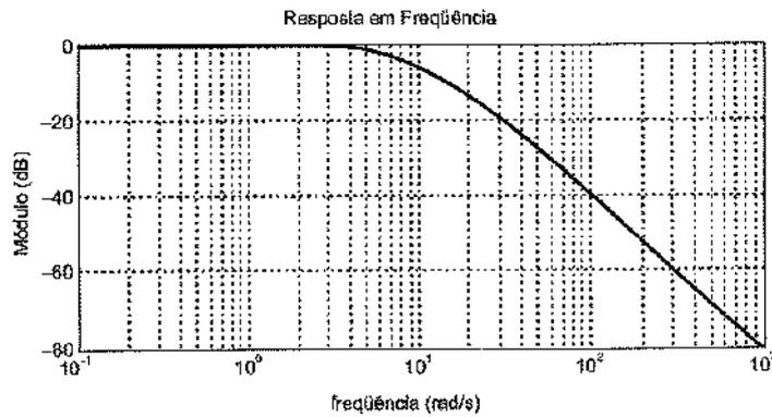
A figura acima representa a curva de módulo (dB) da resposta em frequência de um determinado filtro. Considere dois sinais senoidais de saída em regime permanente com amplitudes  $V_1$  e  $V_2$ , correspondentes a duas entradas senoidais com mesmas amplitudes, mas com as seguintes frequências:  $\omega_1 = 30\text{rad/s}$  e  $\omega_2 = 100\text{rad/s}$ . Qual a relação entre as amplitudes das respostas  $\frac{V_{r1}}{V_{r2}}$ , em regime permanente, aproximadamente?
