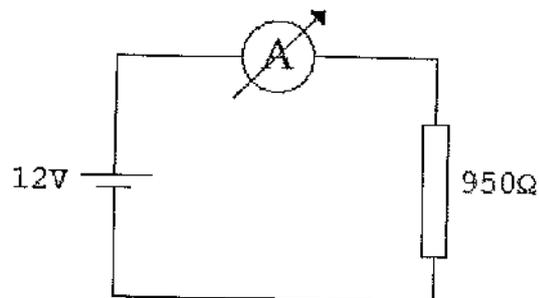
Um amperímetro DC é ligado em série no circuito, conforme representado na figura acima. Considerando que o amperímetro utilizado possui um percentual de redução na leitura de 5%, qual é o valor da resistência interna desse amperímetro, em Ohms?
