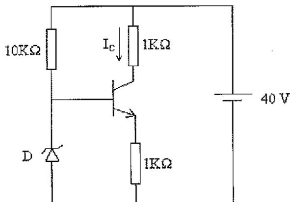
Sabendo que a queda de tensão entre a base e o emissor do transistor é de aproximadamente 0,7V, e que a tensão do diodo Zener D é de 5V, qual é o valor aproximado da corrente, em mA, no coletor do transistor?
