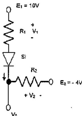
Considerando o diodo de silício com  $V_d = 0,7V$  e os valores de  $R_1$  e  $R_2$ , respectivamente  $4,7 K\Omega$  e  $2,3 K\Omega$ , no circuito acima os valores da corrente ( $I$ ),  $V_1$ ,  $V_2$  e  $V_0$  são respectivamente:
