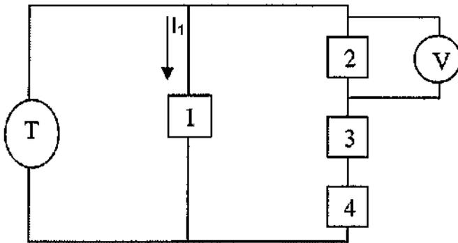
Com base no circuito representado acima e sabendo que os valores das resistências 1, 2, 3 e 4 são, respectivamente,  $10\text{K}\Omega$ ,  $2,2\text{K}\Omega$ ,  $1\text{K}\Omega$  e  $16,8\text{K}\Omega$  e que o valor da tensão no voltímetro T é igual a  $20\text{V}$ , calcule a tensão indicada no voltímetro V e o valor de  $I_1$ , e assinale a opção correta.
