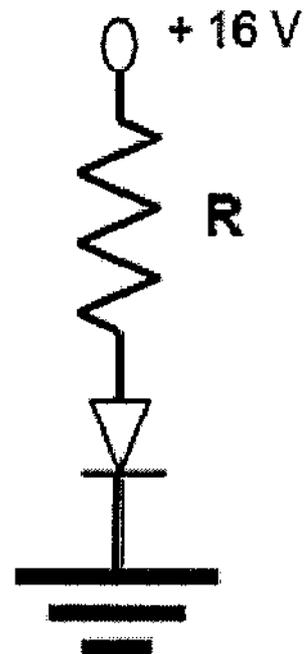
Com base nessa figura calcule o valor de R para se obter uma corrente de silício de 7,65 mA e assinale a opção correta.
