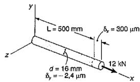
Uma barra de material homogêneo e isotrópico tem 500 mm de comprimento e 16 mm de diâmetro, como mostra a figura acima. Sob a ação da carga axial de 12kN, o comprimento dessa barra aumenta em 300µm e seu diâmetro é reduzido em 2,4µm. Determine o coeficiente de Poisson do material dessa barra e assinale a opção correta.
