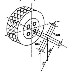
Com base na figura acima, determine o torque de aperto  $(M_T)$  no parafuso da roda do automóvel, no qual a carga aplicada pelo operador em cada braço da chave é F=120N, e o comprimento dos braços é  $\ell$ =200mm.
