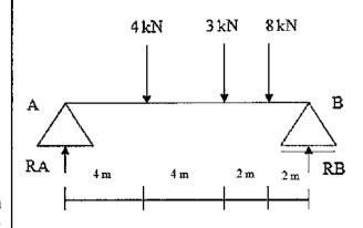
As reações de apoio nos pontos A e B, da viga biapoiada com cargas concentradas, como mostra a figura acima, tem os seguintes valores, respectivamente:
