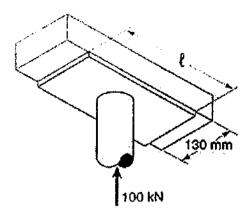
A carga axial na coluna que sustenta uma viga de madeira é de 100 kN, como mostra a figura acima. O comprimento & da placa de apoio para que a tensão de esmagamento média na madeira seja de 3,0Mpa é de, aproximadamente:
