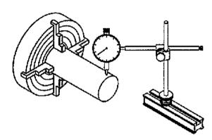
Medir a grandeza de uma peça por comparação é determinar a diferença da grandeza existente entre ela e um padrão de dimensão pré-determinado. Dai originou-se o termo medição indireta. O relógio comparador é um instrumento de medição por comparação, dotado de uma escala e de um ponteiro ligados, por mecanismos diversos, a uma ponta de contato.
