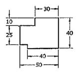
Uma das operações da estampagem é o corte. Qual é o esforço de corte da peça representada pela figura geométrica acima, cuja resistência ao cisalhamento do material é de 0,4 kgf/mm² e a espessura é de 10 mm?
