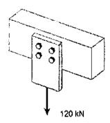
Quatro parafusos de aço são usados para prender uma placa a uma viga de madeira, como mostra a figura acima. Admitindo que a tensão de cisalhamento última para o aço utilizado seja de 300MPa, e desejando um coeficiente de segurança de 3, determine a menor área admissível para que os parafusos sejam usados e assinale a opção correta.
