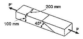
Duas peças de madeira de seção transversal retangular uniforme de 100 x 200mm são unidas por meio de uma emenda chanfrada e colada como indicado na figura acima. Sabendo que P = 20kN, a tensão normal na referida emenda é de, aproximadamente:
