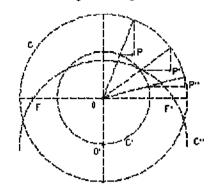
A figura acima apresenta o processo de construção de três pontos pertencentes a uma determinada curva (P, P' e P"). Os pontos P, P' e P" são resultado da interseção de segmentos de reta perpendiculares. O arco de circunferência C" é centrado em O'. Com relação à construção acima, assinale a opção correta.
