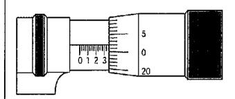
A figura acima representa a leitura, no sistema Inglês, obtida na medição de uma peça, utilizando-se um micrômetro com resolução de .001", que possui 25 divisões. Sendo assim, qual a leitura obtida por esse micrômetro?
