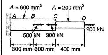
Determine a deformação da barra de aço apresentado pela figura acima sob a ação das cargas indicadas e assinale a opção correta.
