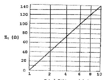
Relação D/d (em escala log) Gráfico de Impedâncias para cabos coaxiais.
