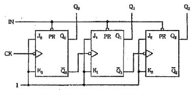
Na figura acima, 3 flip-flops tipo JK são interligados, sendo as entradas clock do 2° e 3° blocos acionadas pelas saídas  $\bar{Q}$  das anteriores. Que tipo de circuito é representado por essa figura?
