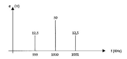
Em uma onda portadora de 100V pico-a-pico e frequência de 1 MHz, é realizada uma modulação com uma informação cossenoidal de 50Vpp e 1Khz. O espectro do sinal modulado é dado na figura acima. Qual é a expressão do sinal modulado?
