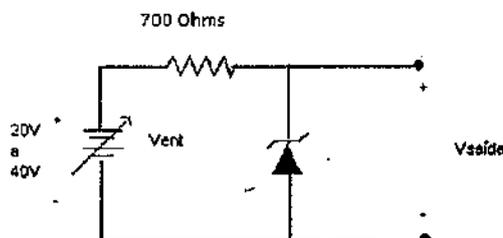
No circuito acima, suponha que o diodo Zener tenha uma tensão de ruptura de 10 V. Sendo assim, quais são os valores mínimo e máximo, respectivamente, da corrente no Zener? (Considere a aproximação ideal para o referido diodo Zener)
