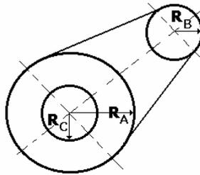
Na figura acima, temos um sistema de transmissão de movimento de um dos motores auxiliares de um navio, formado por três discos A, B e C. Os raios dos discos B e C são iguais e correspondem à metade do raio do disco A. Sabe-se que o disco A move-se solidariamente com o disco B através de uma correia, e que os discos A e C estão ligados ao mesmo eixo central.
