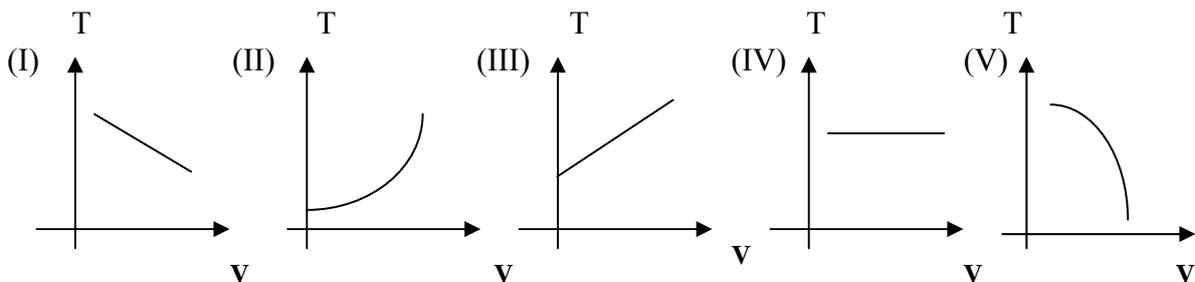
Seja um sistema de vedação a vácuo de vigias a bordo. Suponha que o tempo de resposta de um sistema para chegar-se a 63% da pressão final de vácuo é calculado pela relação  $T = V \times 60 / Q$ , onde V é o volume de ar entre o gerador de vácuo e a ventosa de fixação e Q é a vazão máxima do sistema de tubulação. Dentre os gráficos acima, assinale a alternativa abaixo que melhor representa a variação do tempo com o volume.
