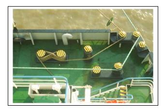
**Cabeço**: coluna de ferro, de altura reduzida, encravada à beira de um cais ou junto à borda de uma embarcação, para nela se dar volta à espia de amarração conforme figura acima.
