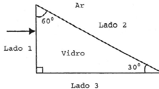
A seção principal de um prisma de vidro, imerso no ar, é um triângulo com ângulos de  $30^\circ$ ,  $60^\circ$  e  $90^\circ$ , conforme indica a figura acima. Um raio monocromático incide na direção da normal do lado 1 deste prisma. Com base nos dados apresentados, é correto afirmar que este raio emergirá pelo lado L e ângulo  $\beta$ , em relação a sua normal, respectivamente, dados pelo item
