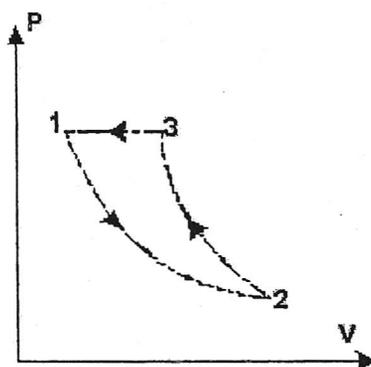
Uma certa massa de gás ideal encontra-se inicialmente no estado termodinâmico 1, indicado no diagrama PV acima. Em seguida, essa massa gasosa sofre uma expansão isotérmica até atingir o estado 2, logo depois uma compressão adiabática até o estado 3 e retornando ao estado 1 através de uma compressão isobárica. Sobre a série de transformações, pode-se dizer que,
