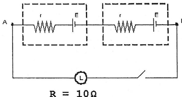
O esquema acima representa o circuito elétrico de uma lanterna com duas pilhas idênticas ligadas em série e uma lâmpada  $L$  com resistência  $R = 10\Omega$ . Com o circuito aberto, a ddp entre os pontos A e B é de 3,0V. Quando o circuito é fechado a ddp entre os pontos A e B cai para 2,5V. A resistência interna de cada pilha e a corrente elétrica do circuito fechado são, respectivamente, iguais a
