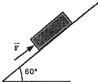
No convés de um navio, um marinheiro apóia uma caixa de massa  $20\text{kg}$  sobre um plano inclinado de  $60^\circ$ , aplicando uma força  $\vec{F}$  de módulo igual a  $100\text{N}$  paralela à superfície inclinada do plano, conforme indica a figura acima. Nestas condições, ele observa que a caixa está na iminência de descer o plano inclinado. Para que a caixa fique na iminência de subir o plano inclinado, ele deve alterar o módulo da força  $\vec{F}$  para
