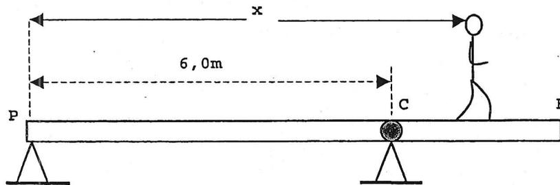
Uma barra PB tem 10m de comprimento e pesa 100kgf. A barra pode girar em torno do ponto C. Um homem pesando 70kgf está caminhando sobre a barra, partindo do ponto P. Conforme indica a figura acima, qual a distância  $x$  que o homem deve percorrer para que a força de interação entre a barra e o ponto de apoio em P seja de 5,0kgf?
