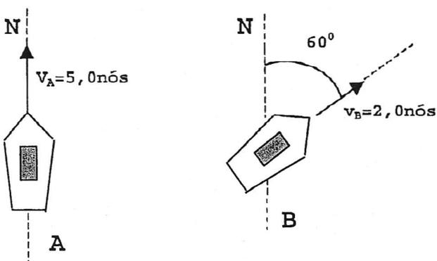
Numa região de mar calmo, dois navios, A e B, navegam com velocidades, respectivamente, iguais a  $v_A = 5,0$  nós no rumo norte e  $v_B = 2,0$  nós na direção  $60^\circ$ NEE, medidas em relação à terra, conforme indica a figura acima. O comandante do navio B precisa medir a velocidade do navio A em relação ao navio B. Que item informa o módulo, em nós, e esboça a direção e sentido do vetor velocidade a ser medido?
