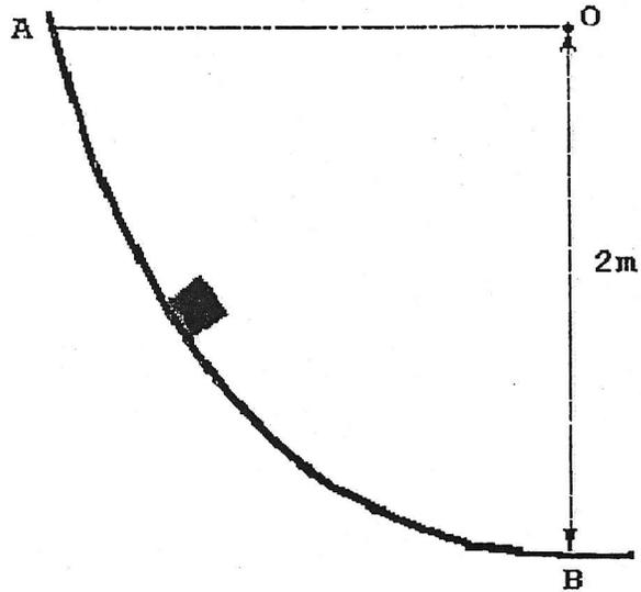
Na figura acima o bloco de massa 30kg, que é abandonado do ponto A com velocidade zero, desliza sobre a pista AB. Considere que ao longo do percurso a força de atrito entre o bloco e a pista dissipa 60J de energia. A velocidade do bloco no ponto B, em m/s, é
