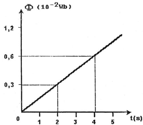
O gráfico acima mostra o fluxo magnético, em função do tempo, que atravessa um anel metálico. Sendo a resistência elétrica do anel igual a  $0,3\Omega$ , a corrente elétrica que o percorre é, em miliampère, igual a
