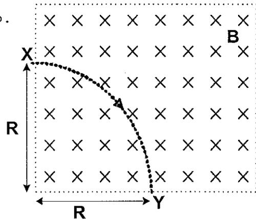
26) Numa dada região do espaço, temos um campo elétrico constante (vertical para cima) de módulo  $E=4,0\text{N/C}$  e, perpendicular a este, um campo magnético também constante de módulo  $B=8,0\text{T}$ . Num determinado instante, uma partícula de carga positiva  $q$  é lançada com velocidade  $\vec{v}$  nesta região, na direção perpendicular, tanto ao campo elétrico quanto ao campo magnético, conforme indica a figura. Com relação à trajetória da partícula, indique a opção correta.
