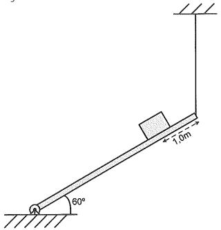
A figura acima ilustra um sistema mecânico em equilíbrio estático, composto de uma tábua de 5,0kg de massa e 6,0m de comprimento, articulada em uma de suas extremidades e presa a um cabo na outra. O cabo está estendido na vertical. Sobre a tábua, que está inclinada de 60°, temos um bloco de massa 3,0kg na posição indicada na figura. Sendo assim, qual o módulo, em newtons, a direção e o sentido da força que a tábua faz na articulação?
