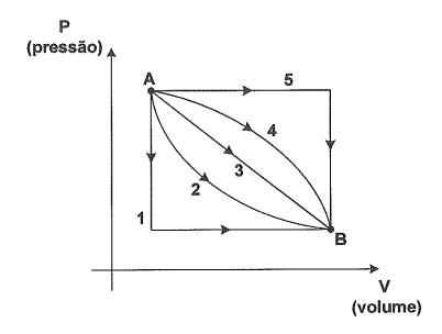
Se entre os estados A e B mostrados na figura, um mol de um gás ideal passa por um processo isotérmico. A(s) curva(s) que pode (m) representar a função P = f(V) desse processo, é(são)
