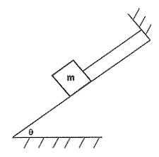
Na figura acima, tem-se um bloco de massa m que encontra-se sobre um plano inclinado sem atrito. Esse bloco está ligado à parte superior do plano por um fio ideal. Sendo assim, assinale a opção que pode representar a variação do módulo das três forças que atuam sobre o bloco em função do ângulo de inclinação  $\theta$ .
