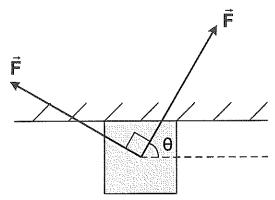
A figura acima mostra um bloco de massa 7,0kg sob uma superfície horizontal. Os coeficientes de atrito estático e cinético entre o bloco e a superfície são, respectivamente, 0,5 e 0,4. O bloco está submetido a ação de duas forças de mesmo módulo, F=80N, mutuamente ortogonais. Se o ângulo  $\theta$  vale 60°, então, pode-se afirmar que o bloco
