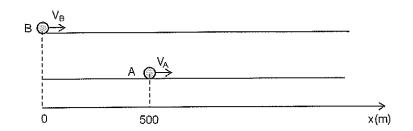
A figura acima mostra duas partículas A e B se movendo em pistas retas e paralelas, no sentido positivo do eixo x. A partícula A se move com velocidade constante de módulo  $v_A=8.0 \, \text{m/s}$ . No instante em que A passa pela posição x=500m, a partícula B passa pela origem, x=0, com velocidade de  $v_B=45 \, \text{m/s}$  e uma desaceleração constante cujo módulo é 1,5m/s². Qual dos gráficos abaixo pode representar as posições das partículas A e B em função do tempo?
