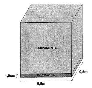
A figura acima mostra um equipamento metálico que está eletricamente isolado do solo por meio de uma base quadrada de borracha com 0,5m de lado, 1,0cm de espessura e resistividade  $10^{13}\Omega$ .m. A máxima ddp entre o equipamento e o solo é obtida para uma corrente máxima de 0,5 $\mu$ A, fluindo uniformemente através da área da base. O valor da ddp máxima, em quilovolts, é
