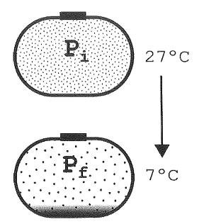
Após uma lavagem, certa quantidade de vapor d'água, na temperatura inicial de 27°C, permaneceu confinada no interior de um tanque metálico. A redução da temperatura para 7,0°C causou condensação e uma consequente redução de 50% no número de moléculas de vapor. Suponha que o vapor d'água se comporte como um gás ideal ocupando um volume constante. Se a pressão inicial for 3,0.10³Pa, a pressão final, em quilopascal, será
