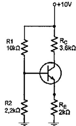
O que acontece com a tensão coletor-emissor do circuito acima se triplicarmos a tensão do coletor?
