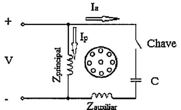
Com base nesses dados, assinale a opção que apresenta o valor do capacitor de partida  $C$  que colocará em quadratura a corrente principal com a corrente auxiliar durante a partida.
