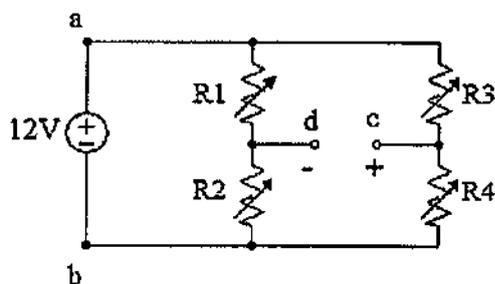
Sabendo que a célula de carga do diagrama acima é alimentada por uma tensão contínua de 12 V e que em dado momento de utilização dessa célula de carga a tensão medida nos terminais "c" e "d" é de 1 V e  $R_1=R_2=R_3=100 \Omega$ , marque a opção que apresenta o valor de  $R_4$ .
