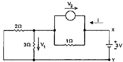
Se  $V_2$  uma fonte de tensão controlada por tensão, cujo valor é  $4V_1$  e onde  $V_1$  é a diferença de potencial aplicada no resistor de  $3\Omega$ , calcule o valor da corrente  $I$  para esse circuito e assinale a opção correta.
