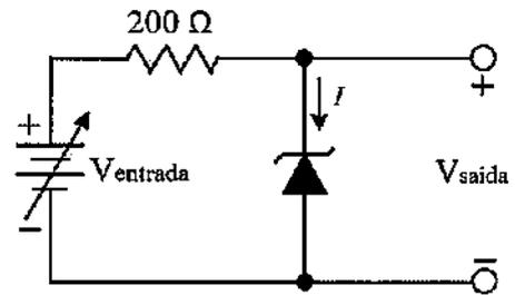
Com base na representação do circuito acima assinale a opção que apresenta a corrente  $I$  no diodo Zener com tensão de ruptura igual a 10 V, quando a tensão de alimentação  $V_{\text{entrada}}$  é igual a 20 V e 40 V, respectivamente.
