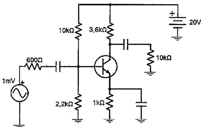
Assinale a opção que apresenta o ganho de tensão (razão da tensão ca do coletor pela tensão ca da base) no circuito acima para  $\beta = 100$ .
