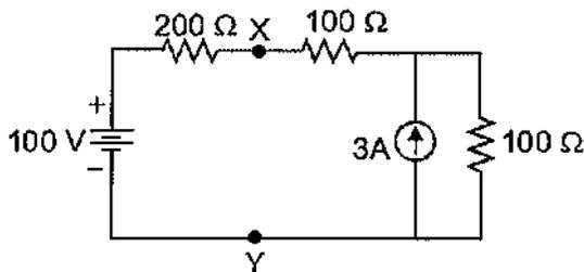
A tensão do Circuito Equivalente de Thevenin, dada em volts e calculada entre os pontos X e Y do circuito acima, é:
