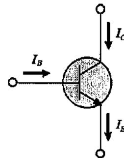
Sendo  $I_B = 50 \mu\text{A}$  e  $I_E = 10 \text{ mA}$ , assinale a opção que apresenta o ganho de corrente  $\beta$  desse transistor.
