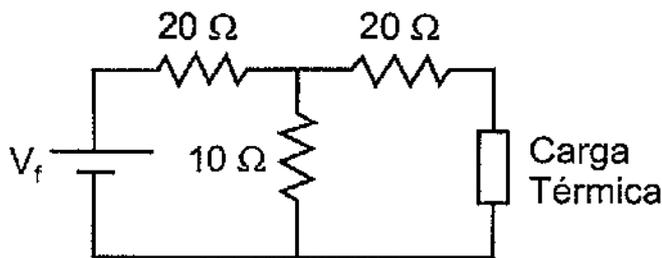
A fonte de tensão desse circuito alimenta, através de uma cadeia de resistores, uma carga térmica que consome 9Kcal/h. Sabendo que a tensão sobre a carga é de 50V, calcule a tensão  $V_f$  da fonte de alimentação, em Volts, e assinale a opção correta.
