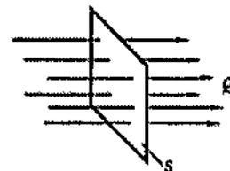
Na figura acima, a superfície S é quadrada, medindo 10 cm por 10 cm, e a indução magnética B do material dessa superfície é igual a 1 T. Sendo assim, assinale a opção que apresenta o fluxo magnético  $\Phi$  que a atravessa.
