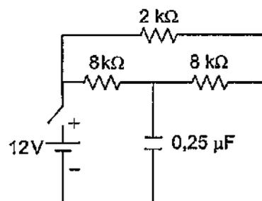
Sabendo que o capacitor representado na figura acima atinge carga máxima após 4 constantes de tempo, quanto tempo, em ms, decorrerá para esse capacitor atingir a carga máxima, após o fechamento da chave?
